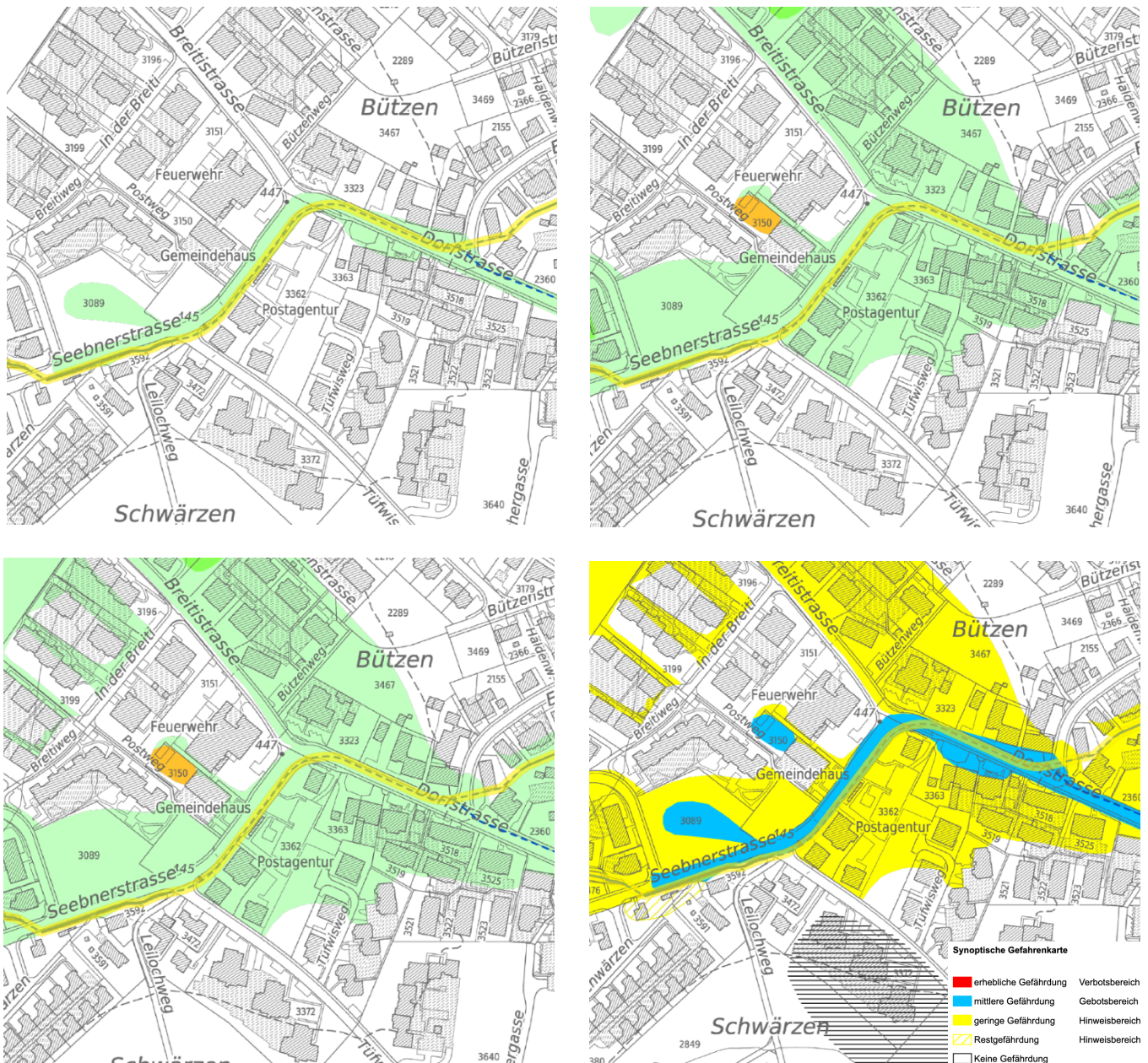
Abb. 36: Intensitätskarten für Hochwasserereignis HQ30, HQ100 und HQ 300 vor den geplanten Massnahmen sowie Gefahrenkarte Hochwasser (EFP AG | maps.zh.ch)
