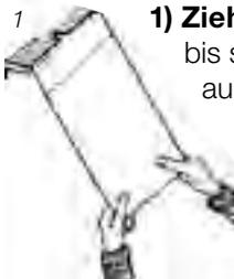
**1) Ziehen Sie den Sack mit beiden Händen gerade nach unten,** bis sich die Nahtstelle (Perforation) des folgenden Sacks ca. 5 cm ausserhalb des Schlitzes befindet.
