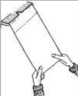
**Ziehen Sie den Sack mit beiden Händen gerade nach unten,** bis sich die Nahtstelle (Perforation) des folgenden Sacks ca. 5 cm ausserhalb des Schlitzes befindet.
